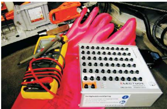
Break-Out-Box am Fahrzeug
