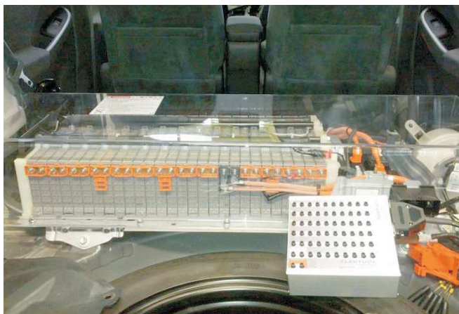
HV-Batterie mit Plexiglasabdeckung und Break-Out-Box mit HV Messpunkten
