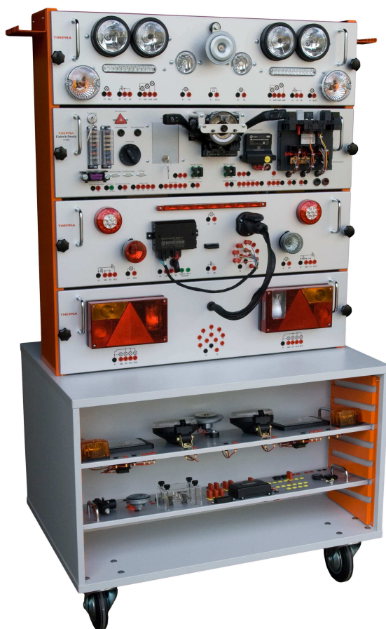
Die Abbildung zeigt die Laborausführung bestückt mit einer CAN-BUS Beleuchtungsanlage
