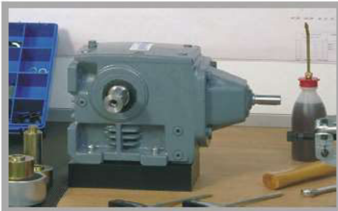
Die Abbildung zeigt das fertig montierte Kombigetriebe.
