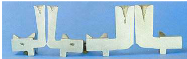
links: Amboss mit kleinem Einguss = Lunkerbildung rechts: Amboss mit großem Einguss = lunkerfreier Guss
