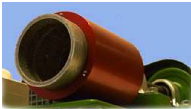
Das fertige Rohrstück wird mittels Ausstoßer aus der Kokille geschoben
