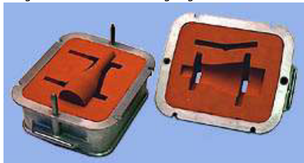
Ausgeformtes Modell mit eingelegtem Sandkern
