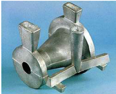
Das fertige Reduzierstück, Eingüsse und Steigern noch nicht entfernt
