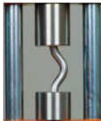
MT3037-23 2 Druckplatten Zur Zentrierung ist eine Markierung vorhanden
