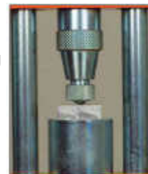
MT3037-23 2 Druckplatten Zur Zentrierung ist eine Markierung vorhanden
