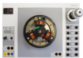
Silnik synchroniczny trójfazowy
