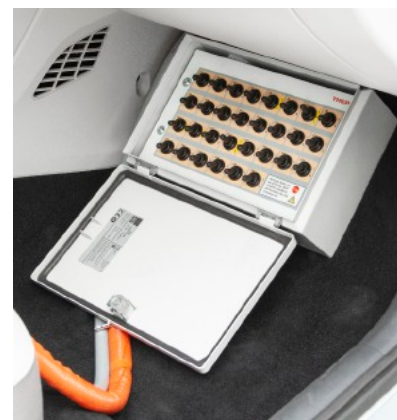
Zamykana Skrzynka Usterek oferuje do 39 przełączalnych błędów.
