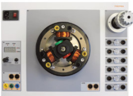
Silnik synchroniczny trójfazowy
