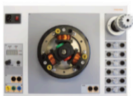
Silnik synchroniczny trójfazowy
